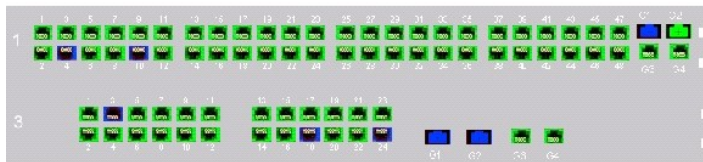
Abbildung 5-2. Port-Anzeigen des PowerConnect-Gerätes
